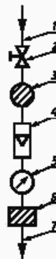
1 — подача воздуха; 2 — вентиль для регулирования воздушного потока; 3 — фильтр для очистки воздуха; 4 — ротаметр РМ по ГОСТ 13045; 5 — манометр мембранный показывающий по ГОСТ 2405; 6 — испытуемый слой волокна; 7 — выход воздуха
